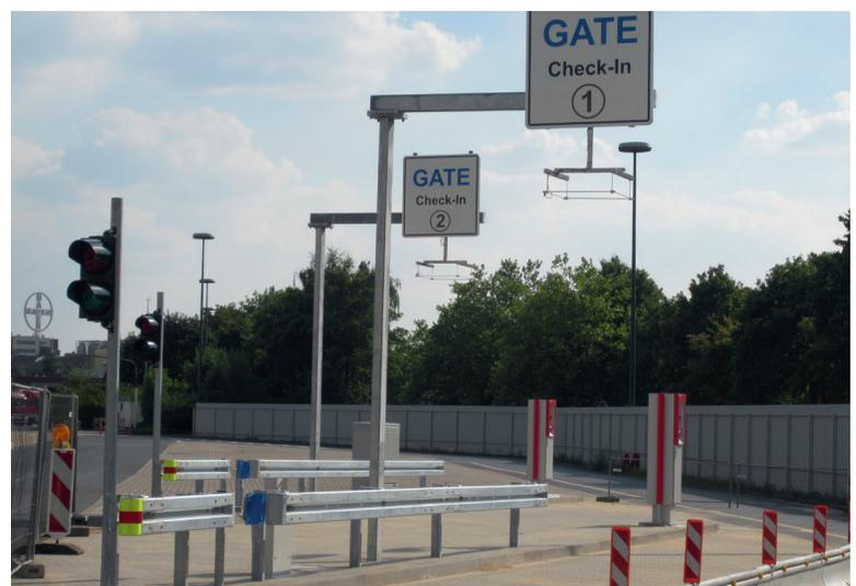
GATE Check-In-Spuren am Autohof: Die am Kragarm angebrachte Rahmenantenne erkennt den auf dem LKW montierten Tag.
