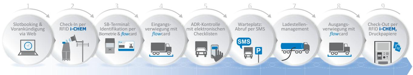
Der GATE-Prozess am CHEMPARK: Zeitersparnis von durchschnittlich einer Stunde bei der Lkw-Abfertigung mit **flow** Technologie
